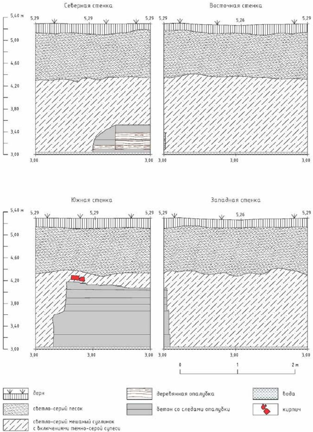
Рис. 21. Санкт-Петербург, пр-кт Металлистов, уч. 77. Шурф 1. Чертежи стенок шурфа
