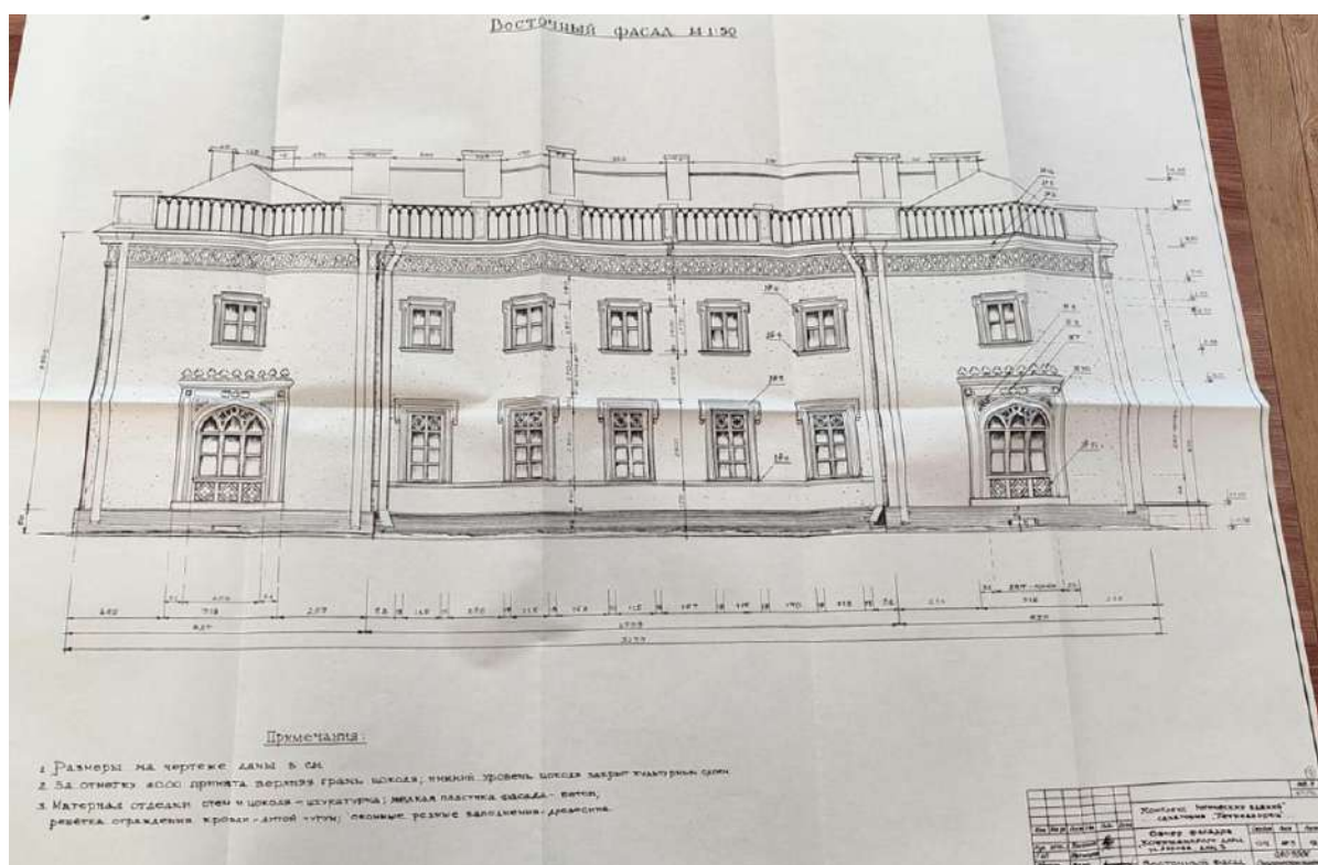
Илл. 19. Обмерный чертеж восточного фасада Кофишенского дома (ул. Аврова, 3). Дата: 2006 г. Автор: ОАО НИИ Спецпроектреставрация. Источник: ЦГАНТД СПб. Фонд Р-467. Описание 315. Дело 301.
