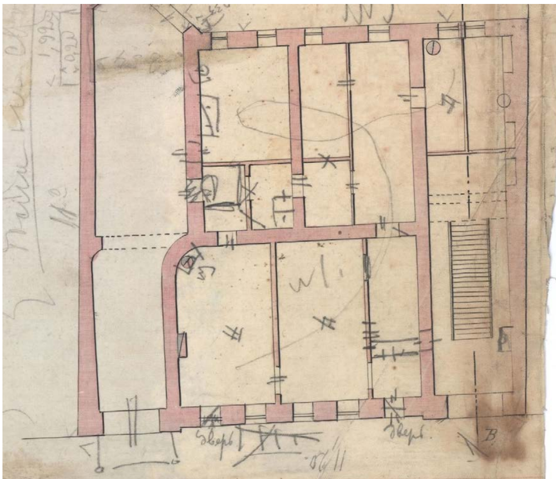
12. Моховая улица, участок № 48/15. Проект архитектора Л. Бонштедта 1851 г. - первый вариант проекта. ЦГИА СПб Фонд 515, Опись 4, Дело 3580, Листы 1 – 4. Фрагмент плана 1 этажа лицевого корпуса по Моховой ул., запроектированы два (непарадных) входа по 2 и 6 осям.
