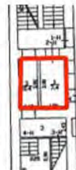
схема размещения крестовых сводов в уровне 1-го этажа
