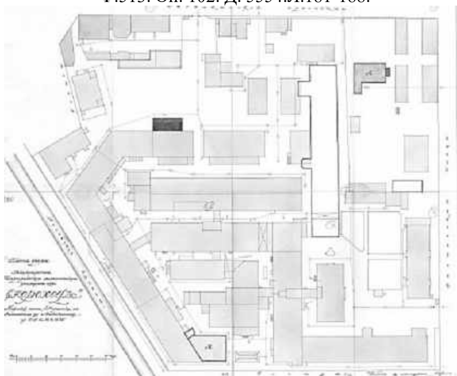
Илл. 62. План двора Товарищества Петроградского механического производства обуви «Скорород». Под лит. А обозначена надстройка корпуса третьим этажом, лит. Б – перестройка одноэтажного склада, лит. В – надстройка корпуса двумя этажами. 1915 г. Арх. Густавсон. ЦГИА СПб. Ф. 513. Оп. 102. Д. 5554.Л.219-226.
