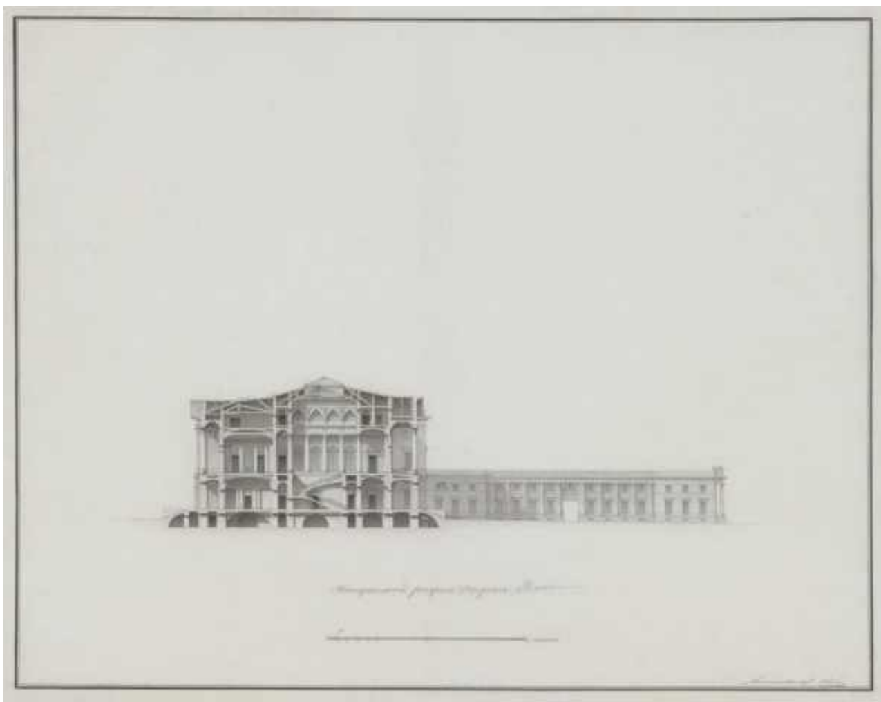
8. К. Росси. Михайловский дворец. Поперечный разрез по главному корпусу и фасада восточного флигеля. Бумага, тушь, отмывка. 1819 г. НИМ РАХ (инв. № А-261)
