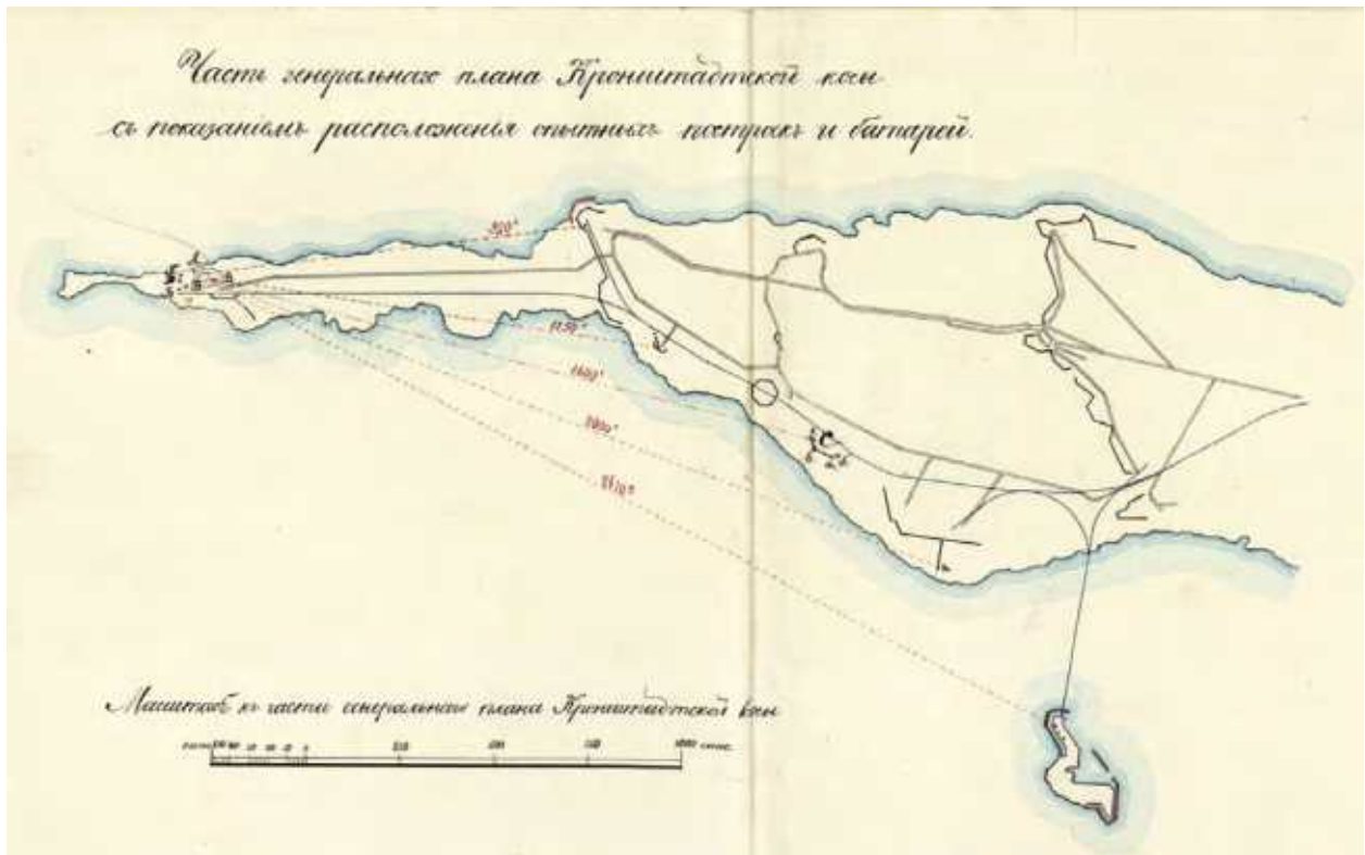
Илл. 8. Схема «Часть генерального плана Кронштадтской косы с показанием расположения опытных построек и батарей». На схеме показаны дальности стрельбы с различных батарей крепости за все годы испытаний. (РГАВМФ. Ф. 1341. Оп. 3. Д. 597).
