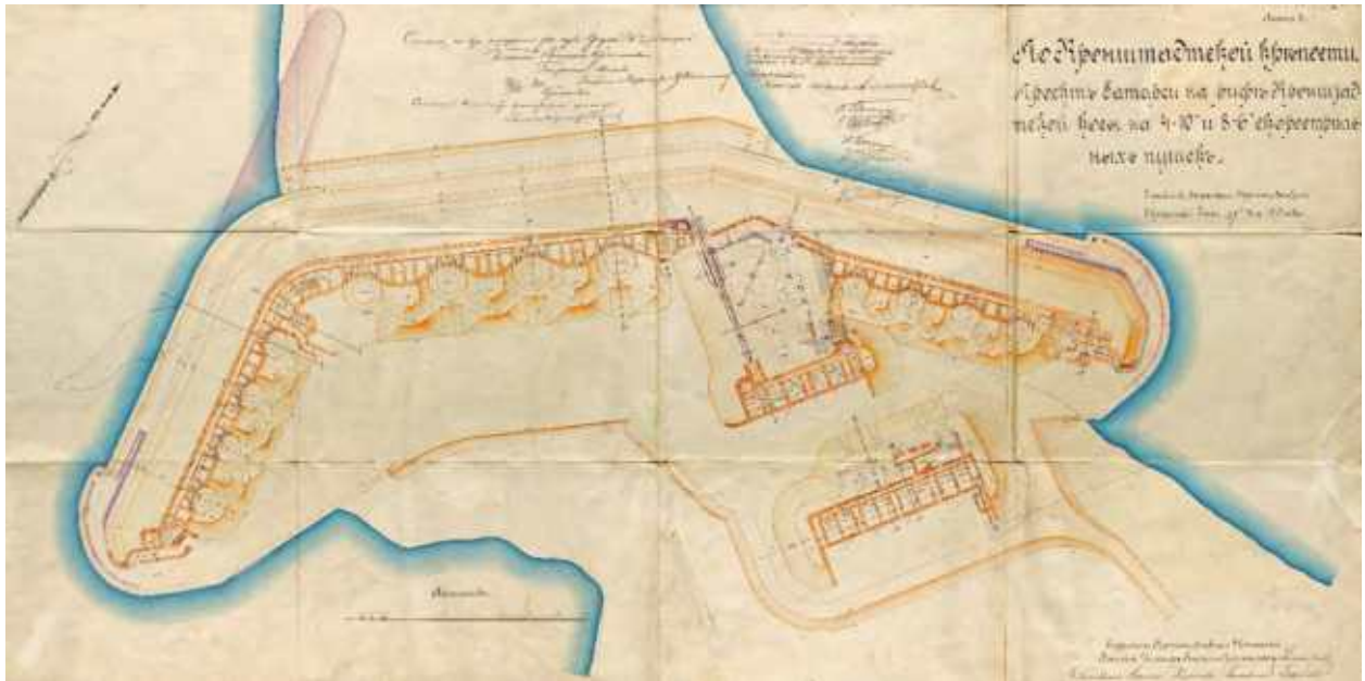
Илл. 75. Проект батареи на рифе Кронштадской косы. 5 августа 1910 г. Фрагмент. (РГВИА. Ф. 349. Оп. 16. Д. 5266-0)
