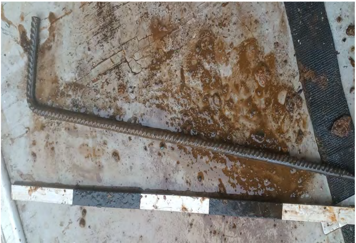
Рис. 132. Аномалия 498. Арматура Ø 10 мм, длина 550 мм.
