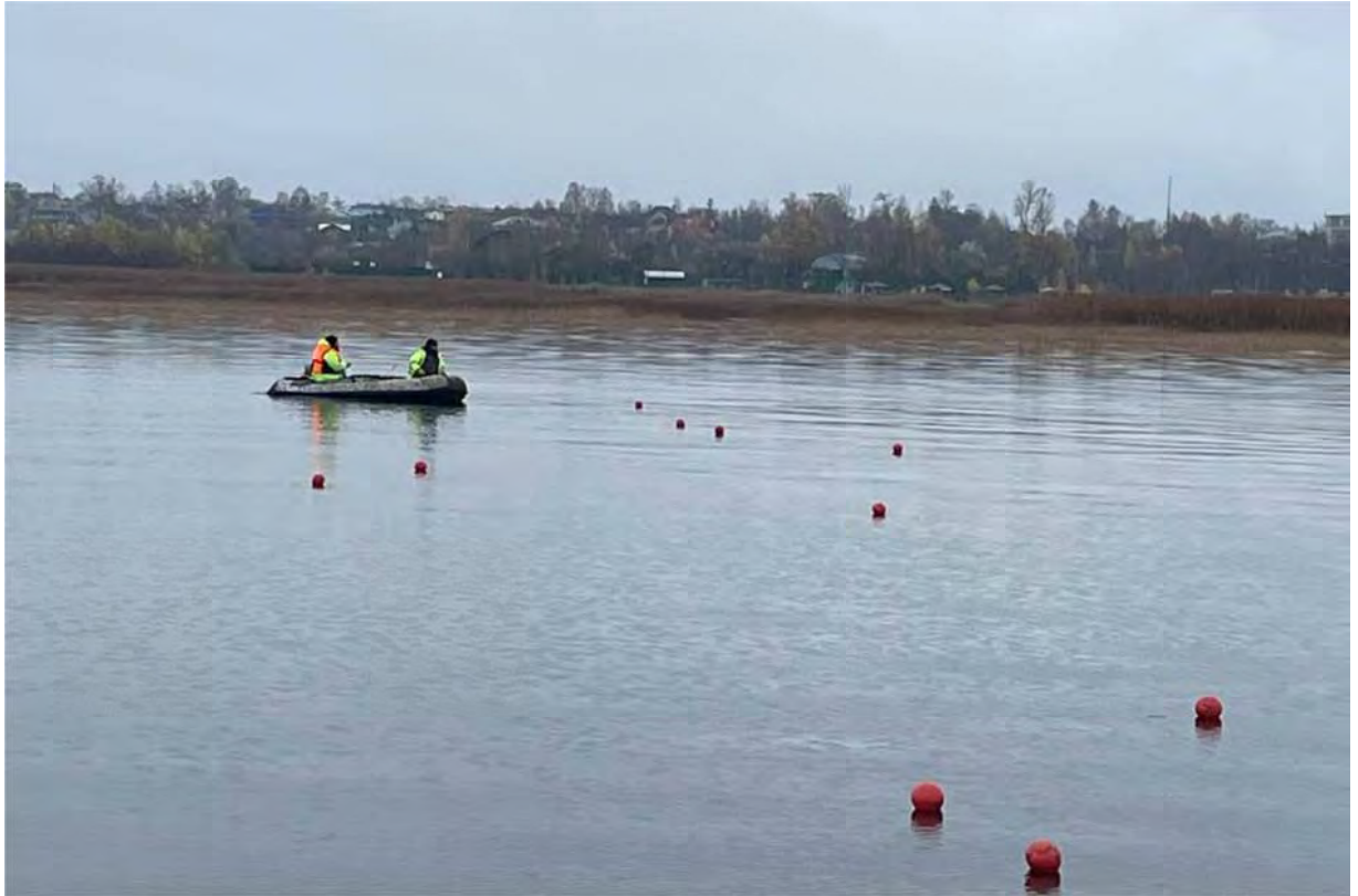
Рис.27. Выставление буйков в координатах магнитных аномалий.
