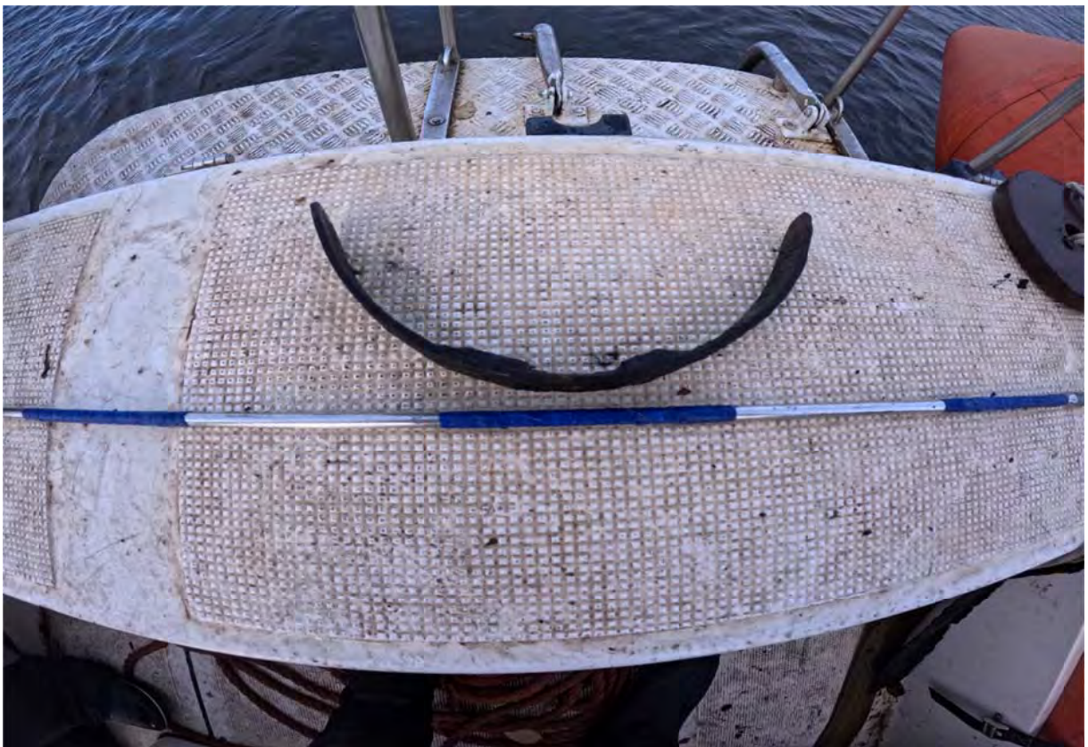
Рис. 90. Аномалия 147. Металлическая полоса 600 × 40 × 10 мм.
