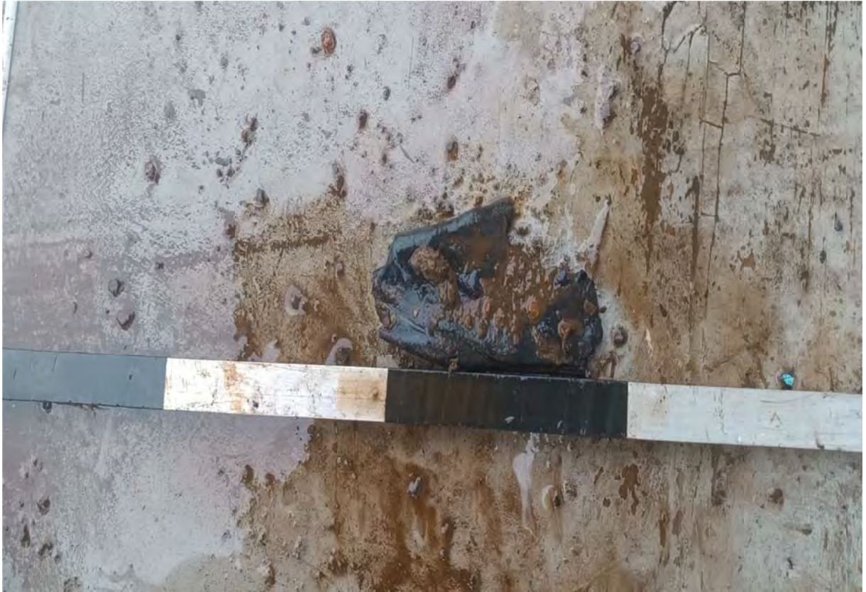
Рис. 111. Аномалия 475. Металлический осколок 50 × 40 мм.
