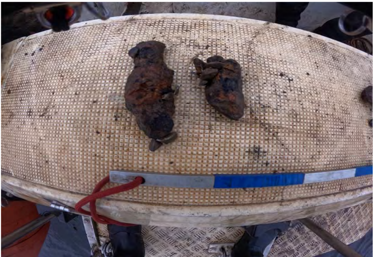
Рис. 42 Аномалия 445. Металлические осколки от 100 \times 20 до 150 \times 30 мм.
