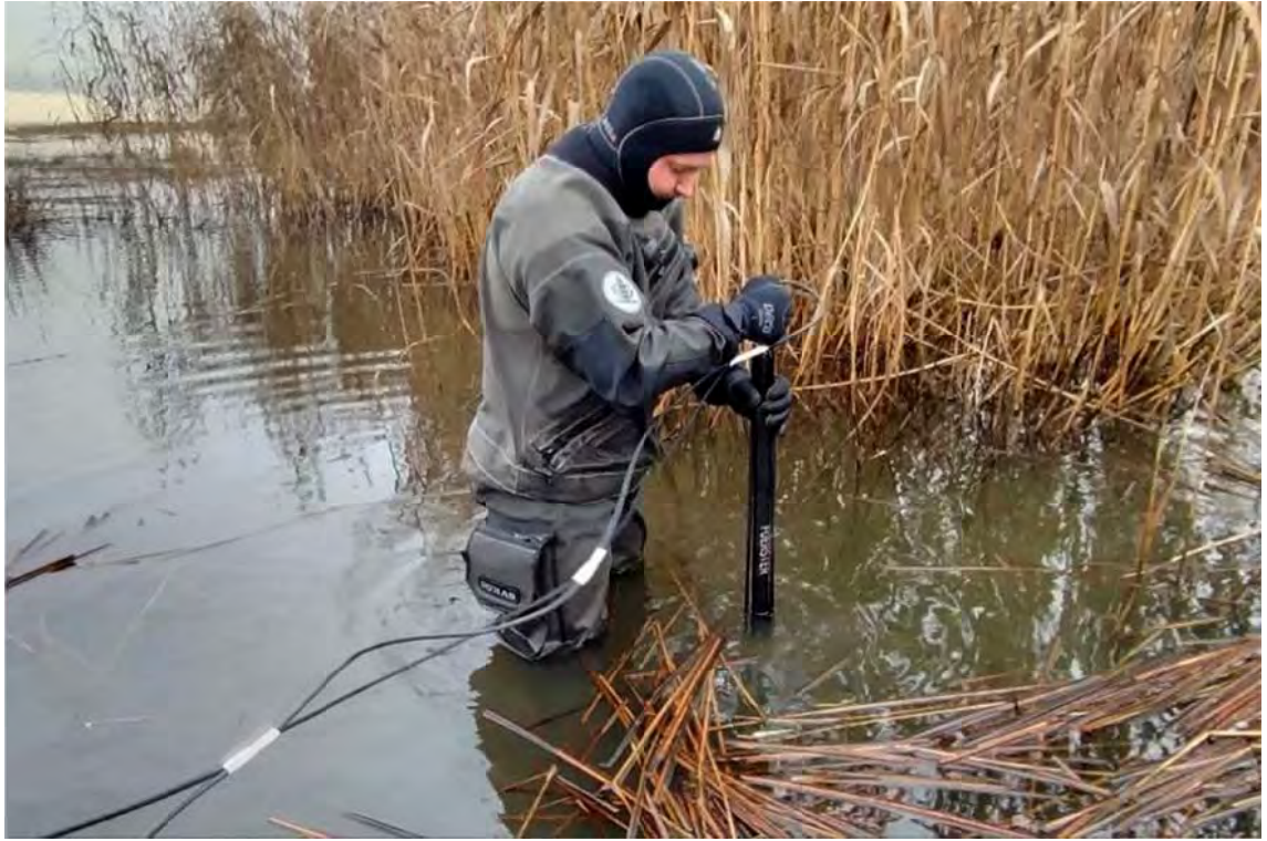
Рис. 31. Обследование мелководья заданного участка градиентометром.
