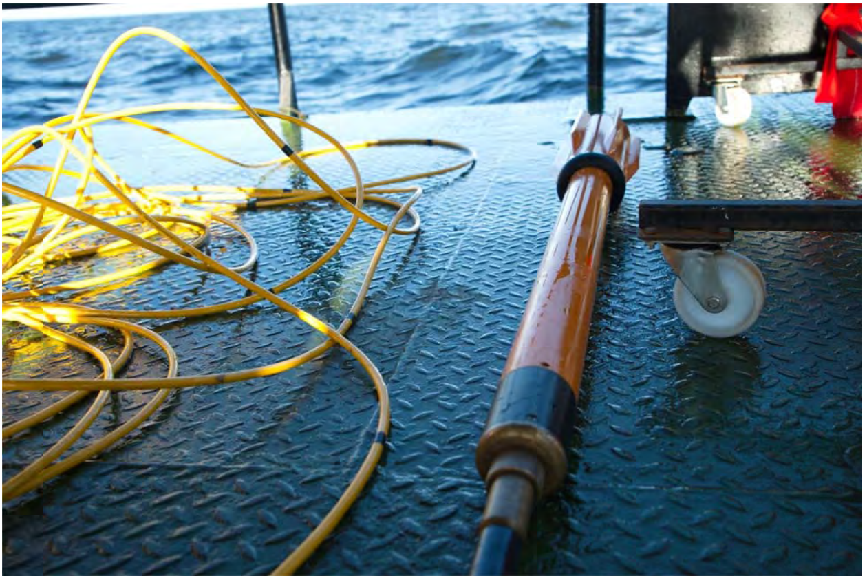
Рис. 15. Буксируемое устройство морского магнитометра.
