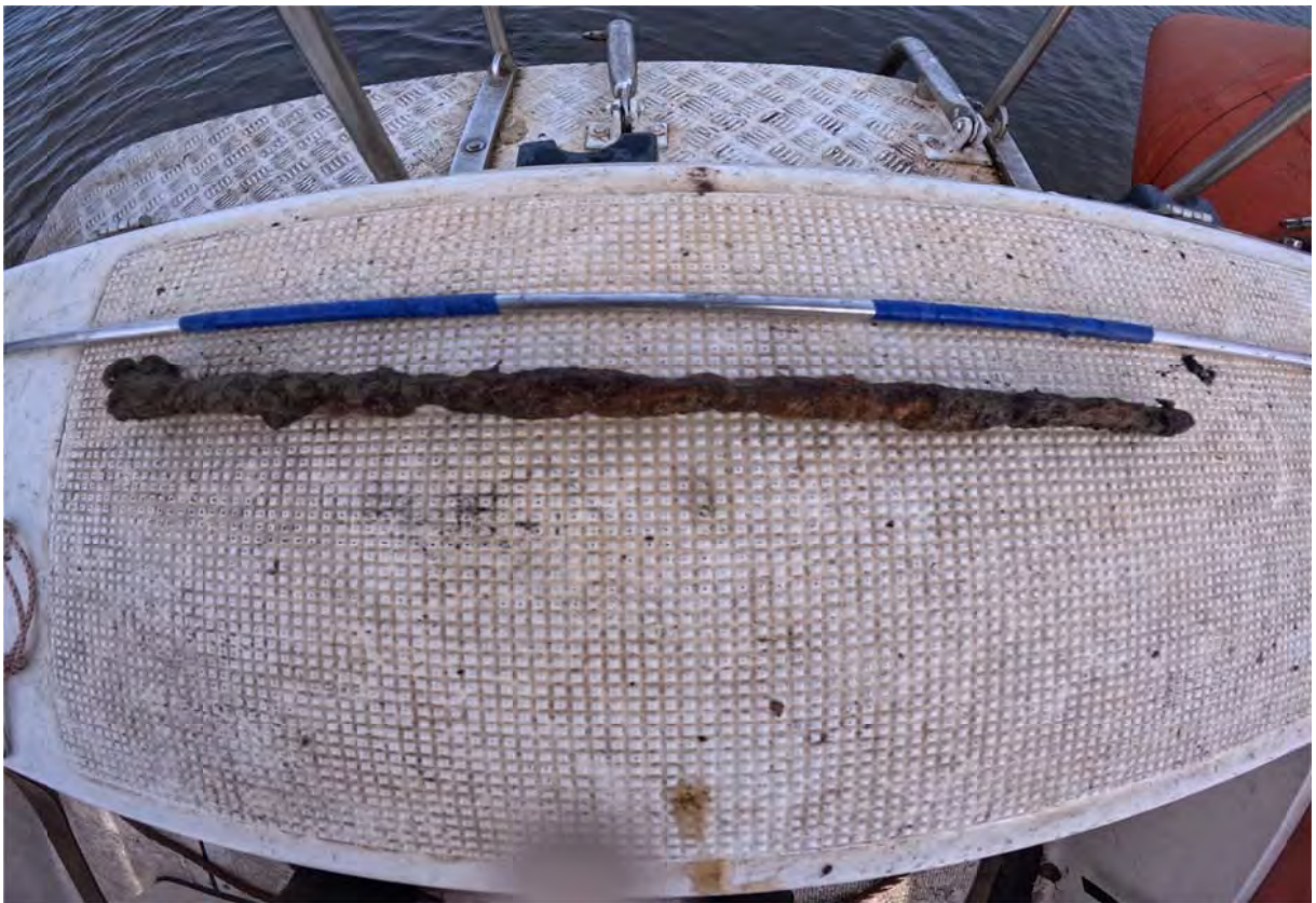
Рис. 86. Аномалия 126. Металлическая арматура \varnothing 10 мм, длина 300 мм.
