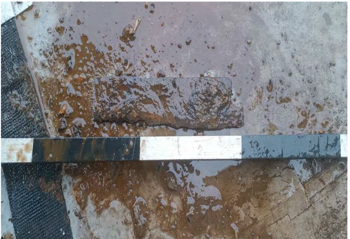
Рис. 128. Аномалия 493. Металлический осколок 80 × 35 мм.
