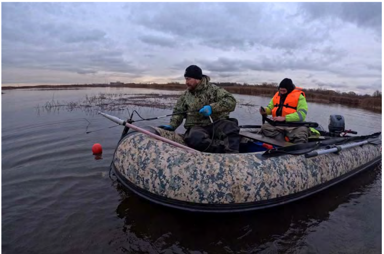
Рис. 28. Уточнение координат магнитных аномалий градиентометром.
