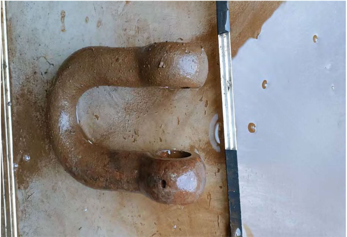
Рис. 179. Аномалия 562. Скоба такелажная типа С65.
