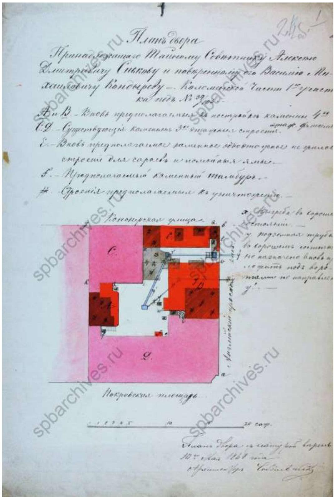
32. 1868. План двора, принадлежащего тайному советнику Алексею Дмитриевичу Сивкову и поверенному его Василию Михайловичу Кондыреву А и В – вновь предполагаемое к постройке 4-этажное каменное С и Д – существующие каменные трехэтажные строения Часть строений сносится ЦГИА СПб. Ф. 513. Оп. 102. Д. 3502. Л. 24об.
