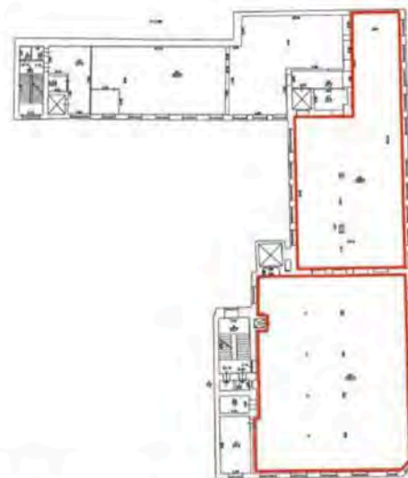
схема размещения конструкций «прусских» сводов в уровне 4-го этажа
