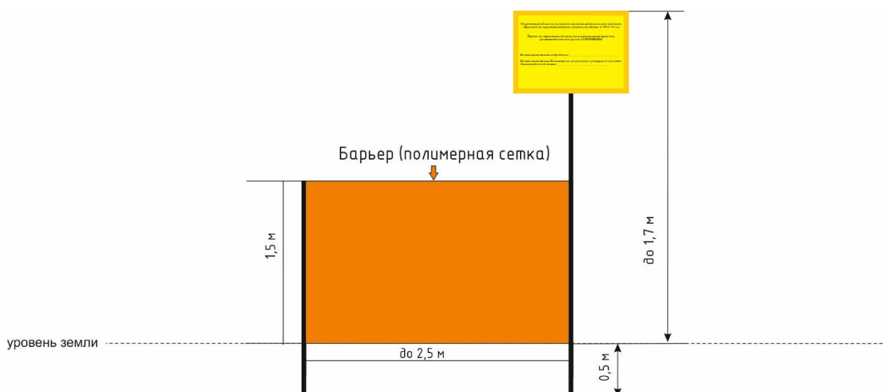
Ограждение объекта культурного наследия (план устройства)
