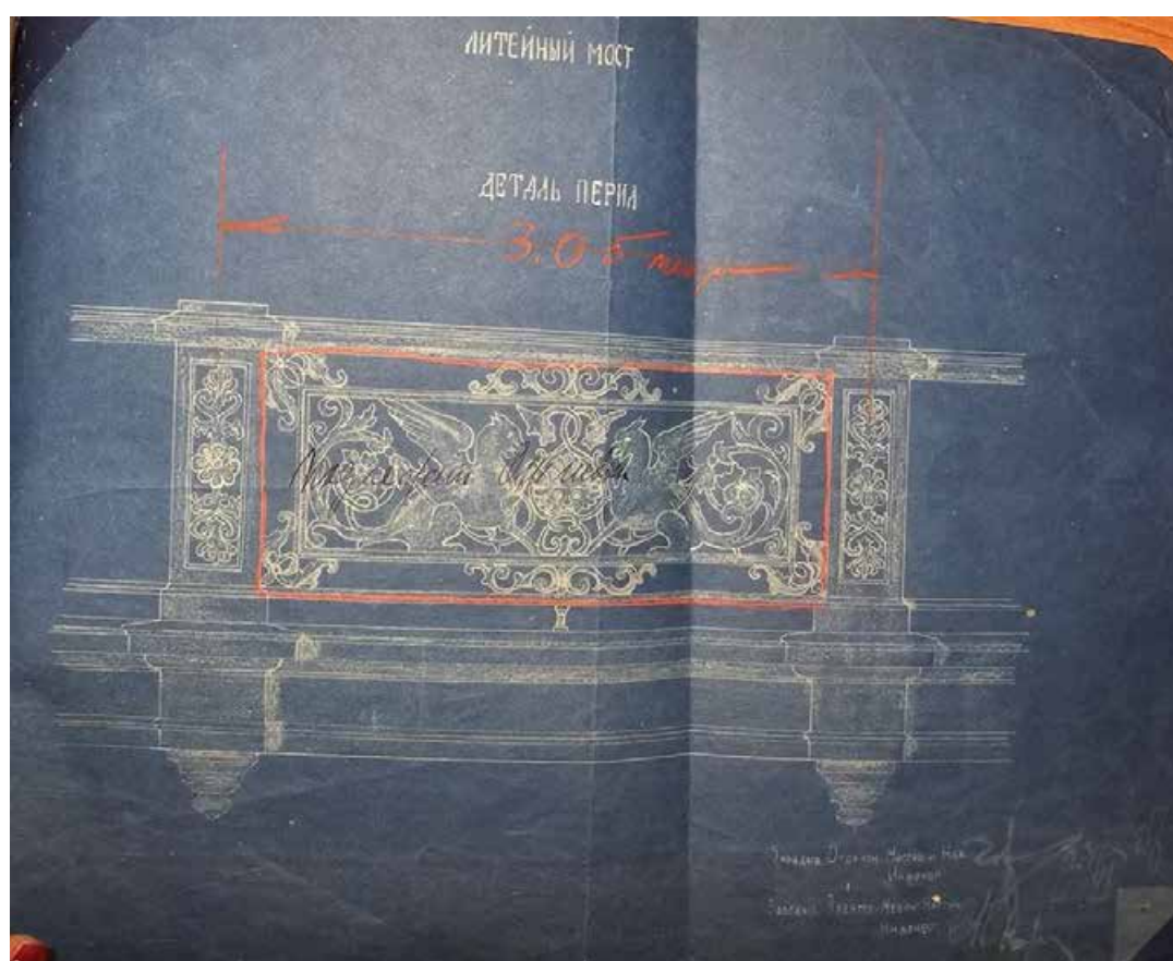
25. Звено ограждения Литейного моста. Вариант. Надпись: «Подлежит отливке». ЦГА СПб. Ф. 119. Оп. 1. Д. 1171.
