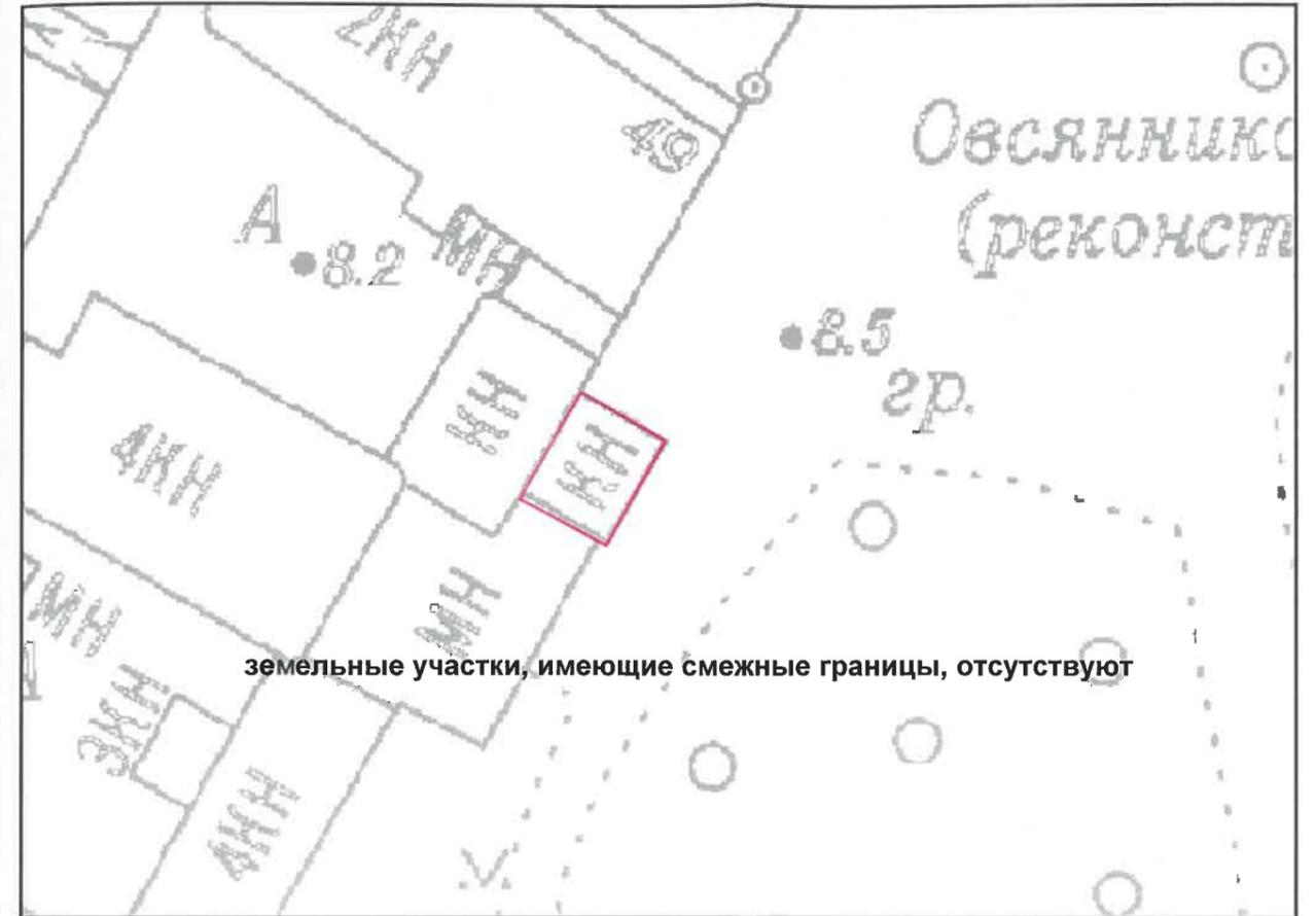
Чертеж градостроительного плана земельного участка разработан на топографической основе, выполненной "Трест ГРИИ" в 2012 г., М1:2000.
