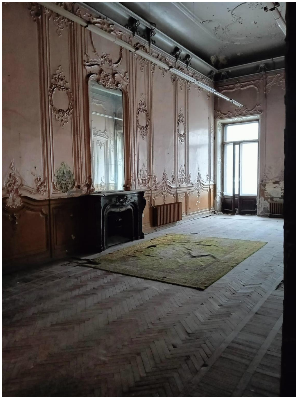
Фото 27. Помещение ЗН(1) (Большая столовая). Общий вид. зеркало потолка обрамлено профилированной фигурной рамой; с высокой падугой сложного профиля, оформленной профилированным карнизом с большим выносом на волютообразных консолях, декорированных ниспадающими гирляндами из листьев; оформление стен – профилированный карниз (служит основанием для кронштейнов падуго).
