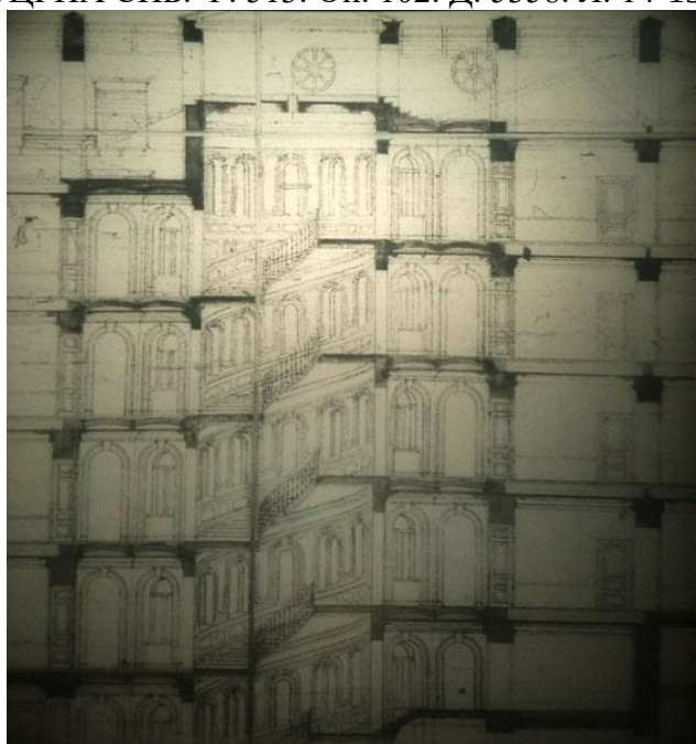
13. Разрез лестницы дома потомственного почетного гражданина Григория Елисеева Московской части 2-го уч. по Чернышеву пер. № 14. 1891 г. /ЦГИА СПб. Ф. 513. Оп. 102. Д. 5358. Л. 16-17/
