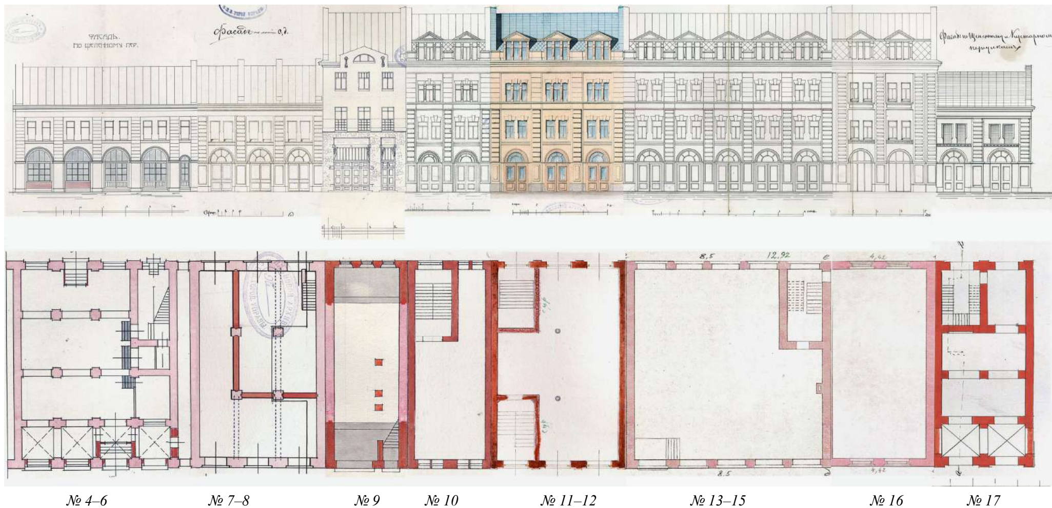
55. Фасад по Щепаному пер. и планы первого этажа здания Сельдяных рядов в 1900-х гг. (сопоставление чертежей и планов секций: ЦГИА СПб. Ф. 513. Оп. 115. Д. 843, 844, 845, 846, 847, 848, 850).
