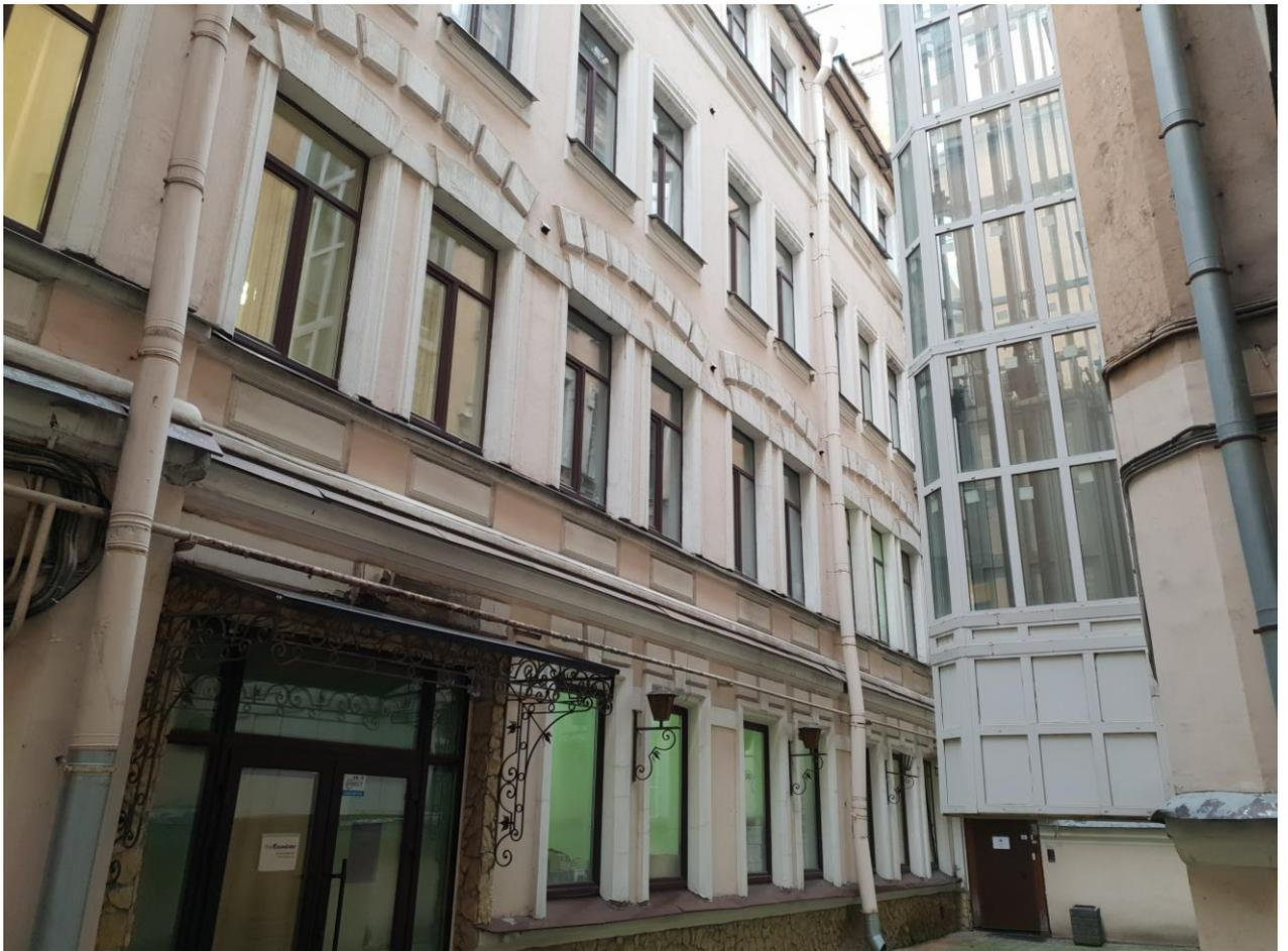
**Фото 24.** Фрагмент северного дворового фасада поперечного 4-х этажного дворового корпуса. Оконные проемы 2-го этажа оформлены стилизованными лучковыми перемычками, стилизованными лучковыми рустованными сандриками; дверной проем с металлопластиковым заполнением под козырьком относится к нежилым коммерческим помещениям, цоколь облицован современным материалом.
