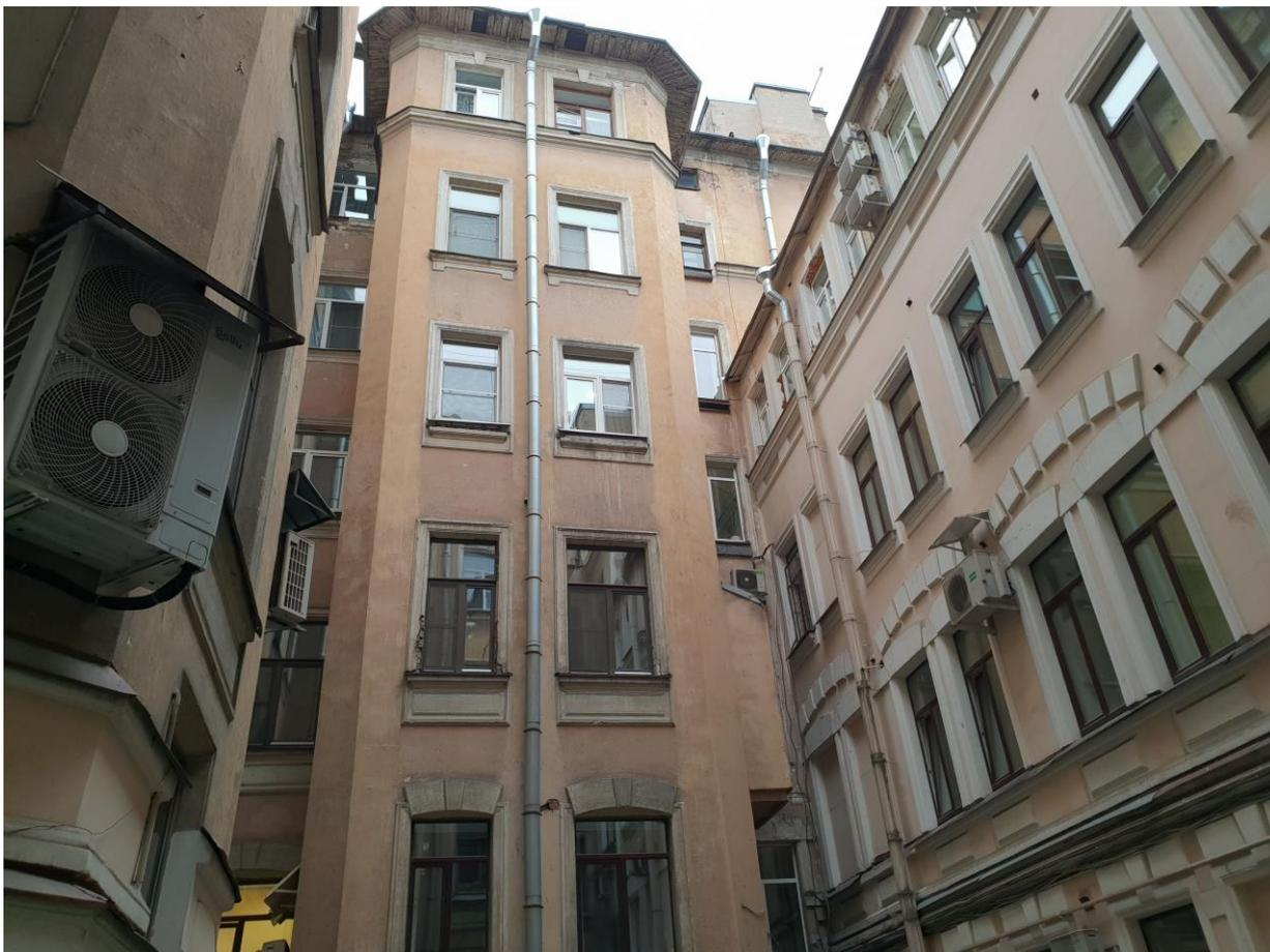
**Фото 31.** Вид на дворовые фасады северного двора сложной конфигурации: справа фрагмент южного дворового фасада поперечного 4-х этажного дворового корпуса, в центре фрагмент восточного дворового фасада с выступающим пятигранным ризалитом на две оси, венчающим выносным карнизом с подшивкой деревом на деревянных кобылках; слева – фрагмент ризалита лестничной клетки дворового северного фасада лицевого 5-и этажного лицевого корпуса по 2-й Советской ул.
