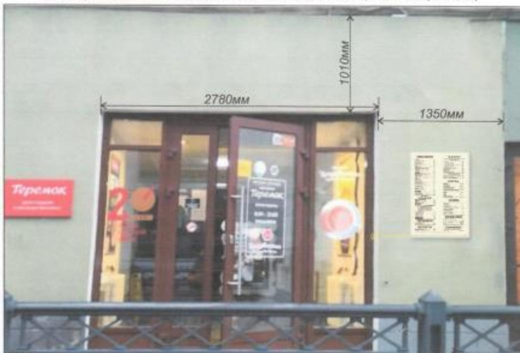
Объемный световой короб-меню. Сменная текстовая информация. Лицо - молочный акрил, пленка Оракал 8500, боковины - пластик пвх 3мм, пленка Оракал 641. Подсветка осуществляется светодиодными кластерами. Монтаж элементов осуществляется через металлоконструкцию на шпильки вплотную к фасаду.
