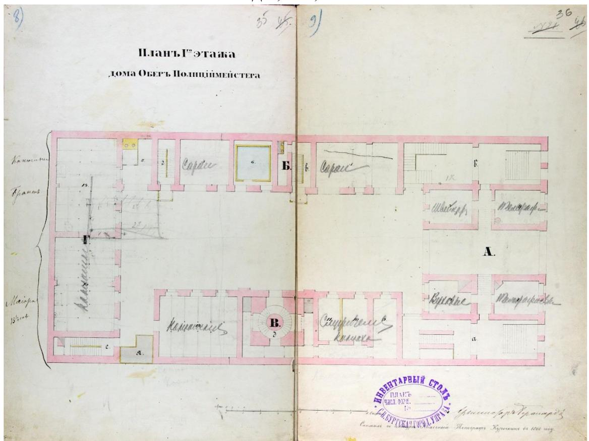
Илл. 35. План 1-го этажа. Фиксационный чертеж 1860 г. — ЦГИА СПб. Ф. 513. Оп. 101. Д. 3, л. 35, 36.
