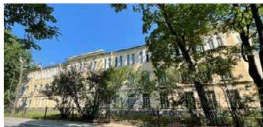
оформление оконных проемов – профилированные наличники, соединённые между собой профилированными тягами в междуоконном пространстве (в уровне 1-го этажа); архивольты (в уровне 2-го этажа); гладкие наличники и архивольты (в уровне 3-го этажа);
