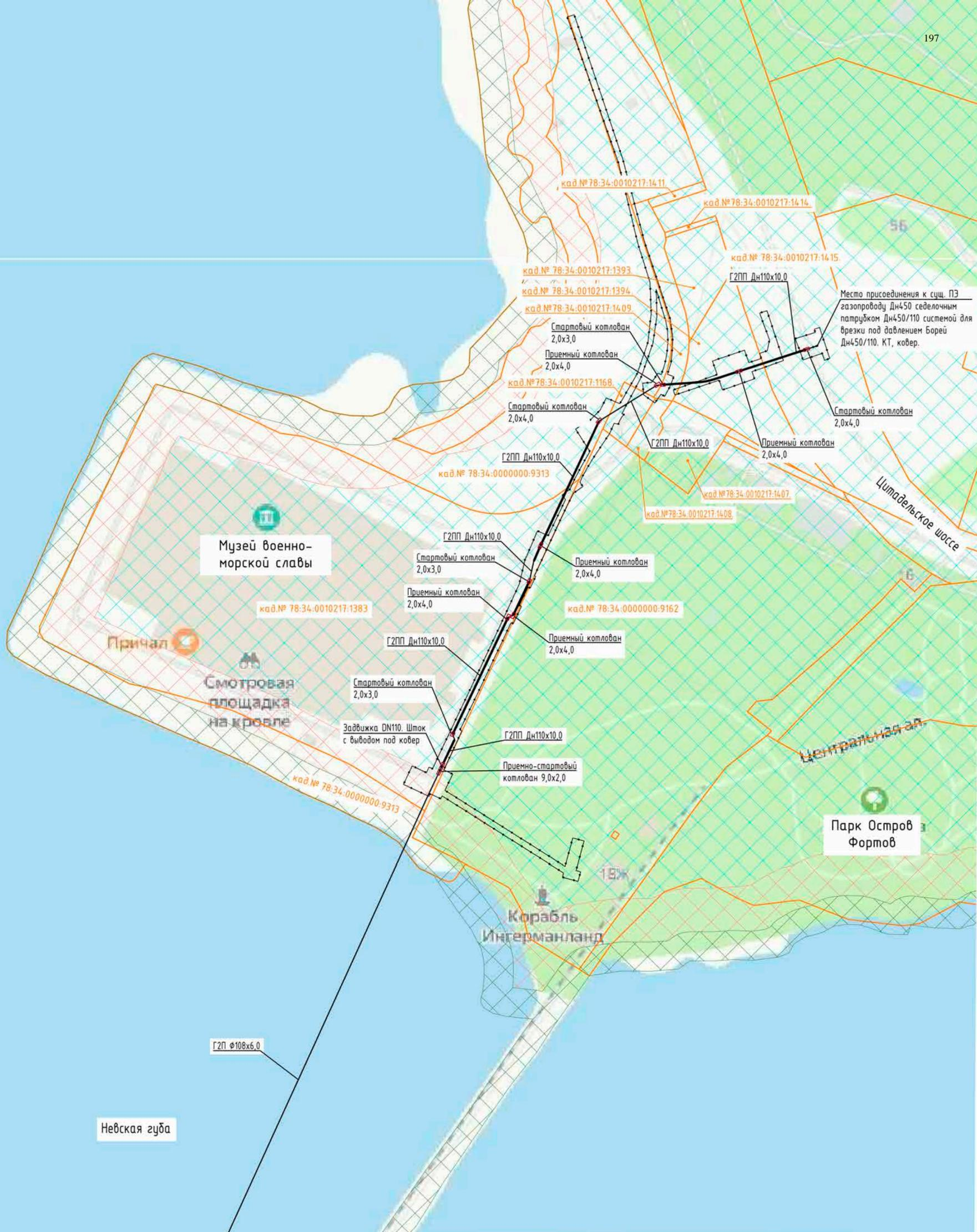
Место присоединения к сущ. ПЗ газопроводу Дн450 седельным патрубком Дн450/110 системой для врезки под давлением Борей Дн450/110, КТ, ковер.
