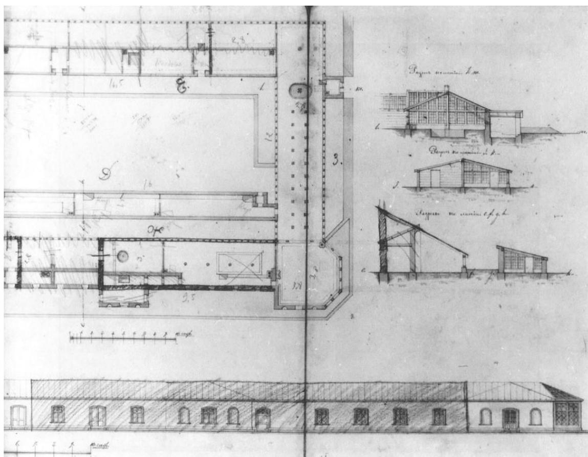
17. Фасады, разрезы и план служебных зданий. Фиксационный чертеж.
