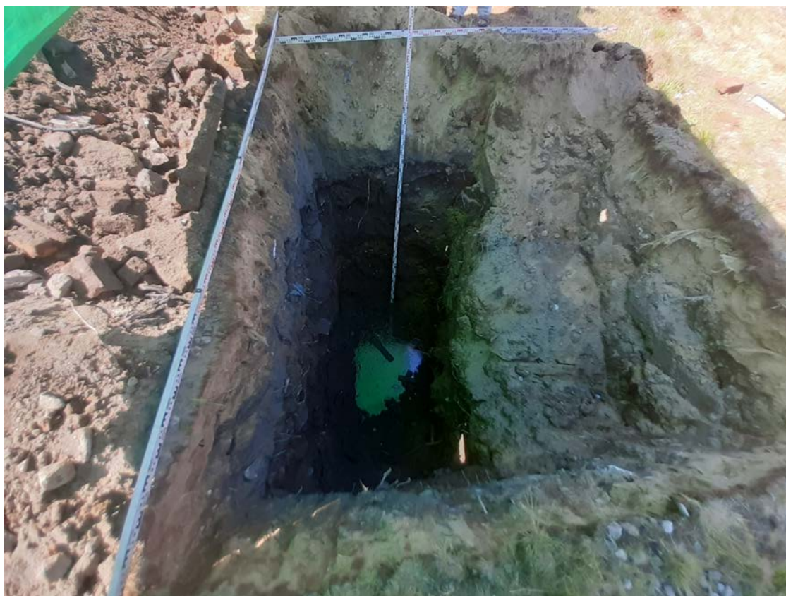
Рис. 44. Санкт-Петербург, Приморский р-н, Приморский пр., участок 114. Шурф 1. Фотофиксация на уровне затопления шурфа грунтовыми водами. Вид на запад.
