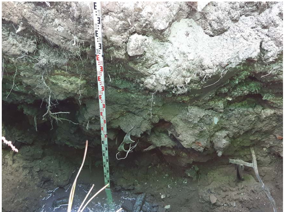
Рис. 54. Санкт-Петербург, Приморский р-н, Приморский пр., участок 114. Шурф 1. Фотофиксация крупным планом техногенного насыпного грунта в северной стенке.
