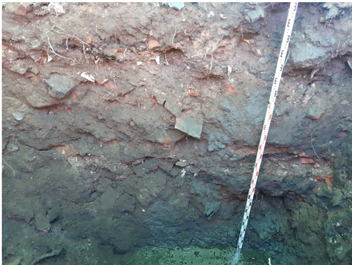
Рис. 48. Санкт-Петербург, Приморский р-н, Приморский пр., участок 114. Шурф 1. Фотофиксация техногенного насыпного грунта крупным планом в стратиграфии южной стенки.
