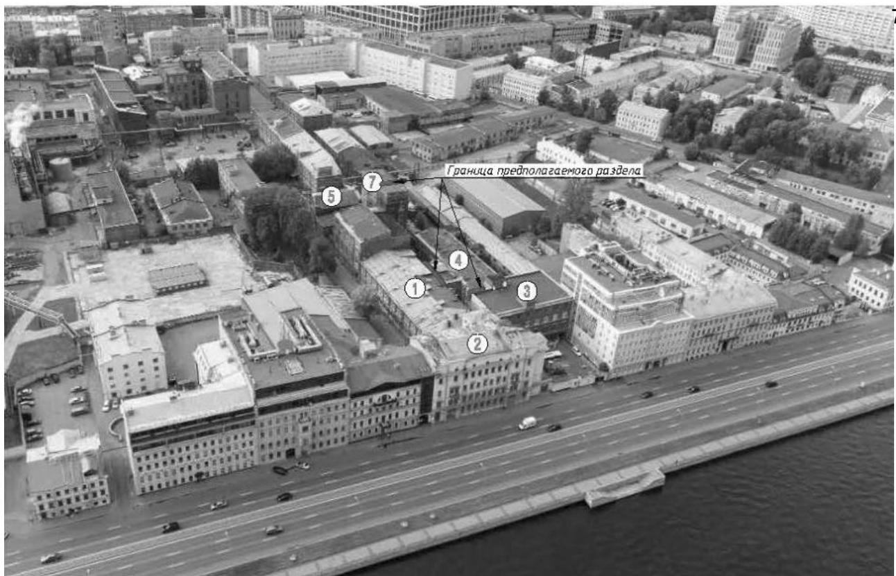
Фотография №1. Съемка с квадрокоптера. Места стыка корпусов. Двускатные кровли с различными высотными отметками конька и венчающего карниза.
