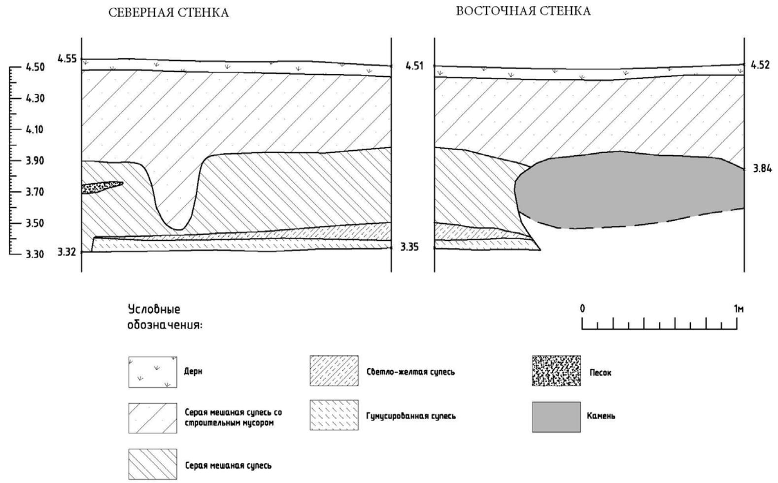
Рис. 39. СПб-2023. Крыленко ул. д.1а, лит. М (КН78:12:0006334:35). Шурф 1, стратиграфические разрезы стенок.
