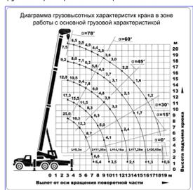
Расчет грузоподъемности автомобильного крана с вылетом стрелы 6 м
