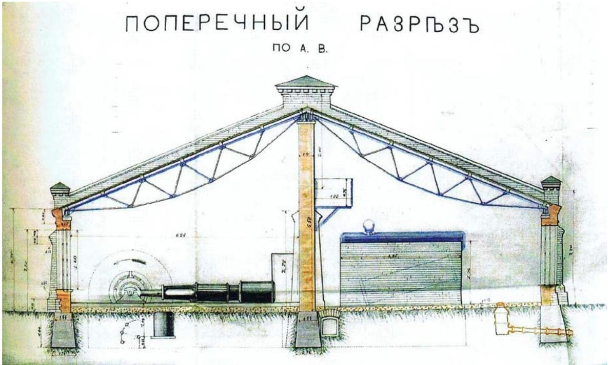
8. Проект постройки электрической станции на станции Санкт-Петербург. Продольный разрез. — РГИА. Ф. 350. Оп. 44. Д. 97.
